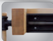
Besonders massive Linearführung an der Hinterzange
