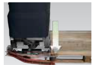
Reinigungsbürsten mit automatischem Einzug bei Stößen
