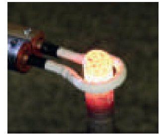
› Erwärmen eines Gewindebolzens mit der wassergekühlten Spule
