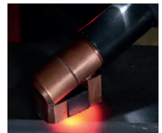
› Erwärmen eines Bauteils mit der Fokusspule seitlich
