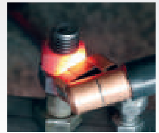
› Erwärmen einer Mutter mit der Fokusspule schräg
