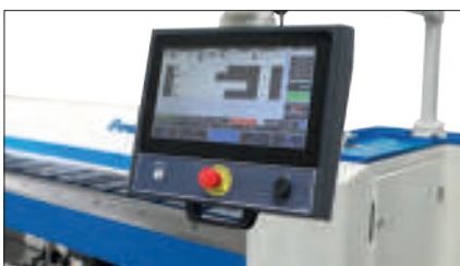
Bedienerfreundliche 15,6“ Touchscreen NC-Steuerung an ergonomischen Schwenkarm
