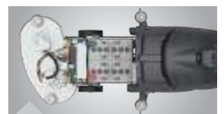
Bürstenköpfe austauschbar, dadurch nur eine Maschine mit unterschiedlichen Bürstenköpfen verwendbar statt verschiedene Maschinen
