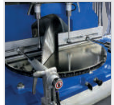
▶ Stufenlose Verstellung des Gehrungswinkels
