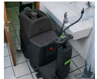
Frischwassertank mit Schlauch für Schnellbefüllung
