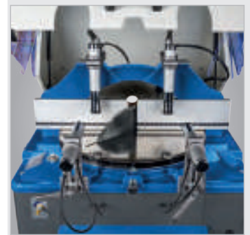
▶ Serienmäßig mit vier pneumatischen Spannzyllindern
