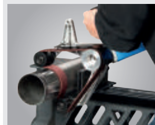
▶ Nur zwei Arbeitsschritte notwendig für 360° Umfangschleifen
