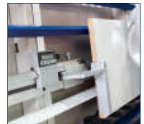
• Digitale Maßanzeige zur Längeneinstellung beim Vertikalschnitt
