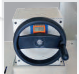
MTBS 2103 F ▶ Bedienung des Hinteranschlags von der Maschinenfront über Handrad und Zählwerk
