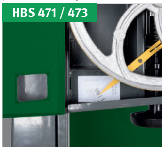
HBS 471 / 473 Die Sägebandspannung ist von außen durch ein in der Tür integriertes Sichtfenster ablesbar
