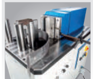
▶ Mit Schnellwechselaufnahme und Seitenanschlag mit Skala
