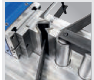
▶ Mit Schnellwechselaufnahme und Seitenanschlag mit Skala
