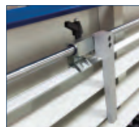
• Lineal zur Längeneinstellung beim Vertikalschnitt
