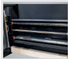
▶ Die über Kugelumlaufspindeln angetriebene X-Achse läuft auf doppelter Linearführung
