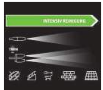
Stufe 2: Modus mit 2 Pumpen , dadurch höherer Arbeitsdruck und Wasserfluss für starke Verschmutzungen
