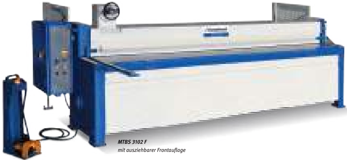
▶ Rückraum durch Lichtschranke abgesichert
