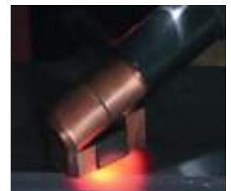
› Erwärmen eines Bauteils mit der Fokusspule seitlich
