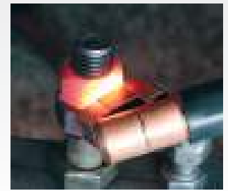
› Erwärmen einer Mutter mit der Fokusspule schräg
