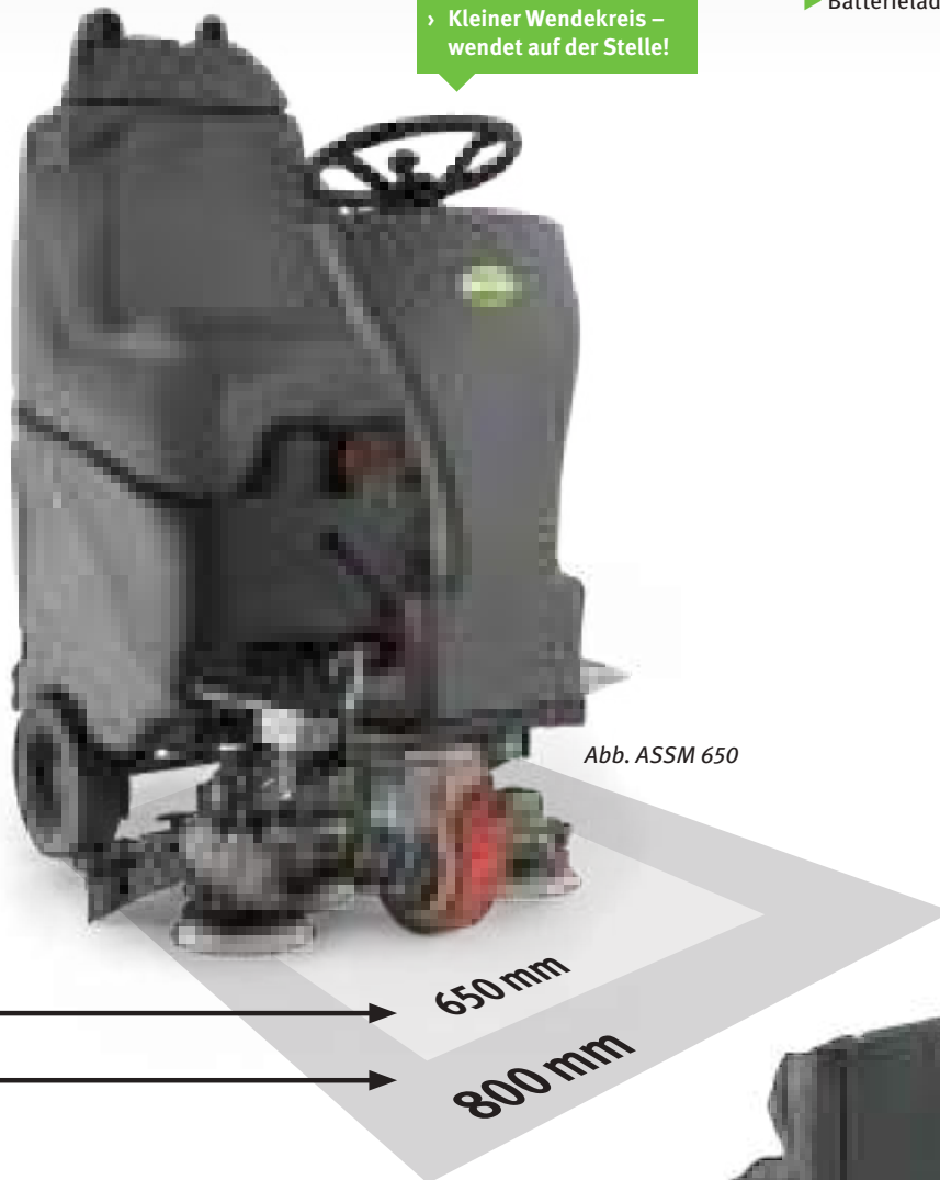
Vier kleine Scheibenbürsten, mit direkt dahinter liegender Absaugleiste, ermöglichen eine kurze Bauform und einen sehr kleinen Wendekreis
