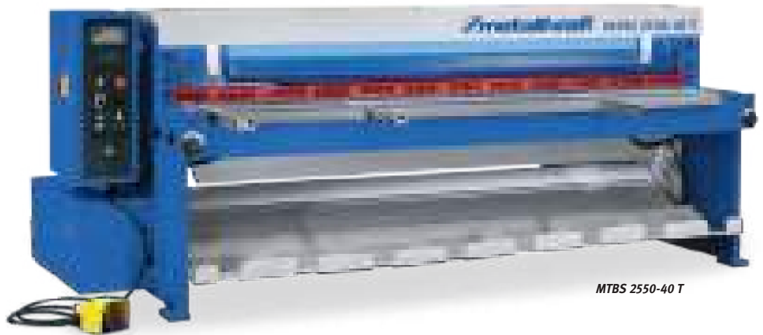
▶ Rückraumsicherung nach CE mit Seitenblechen und Lichtschränke
