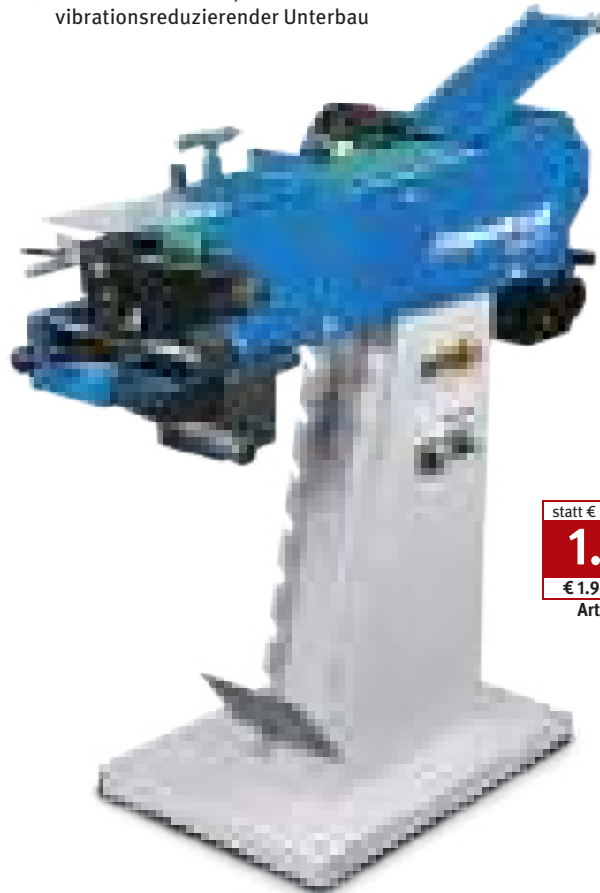
Abb. zeigt Rückseite zum Entgratschleifen mit praktischer Werkstückauflage und Späneauffangbehälter
