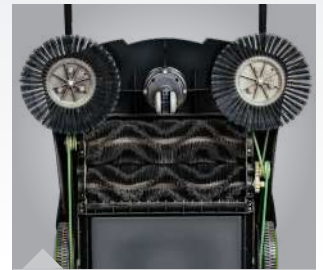
Abb. zeigt HKM 700 mit Tandem-Walzen-System
