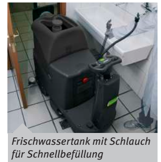
Ergonomischer Lenker mit Bedienelementen und Display
