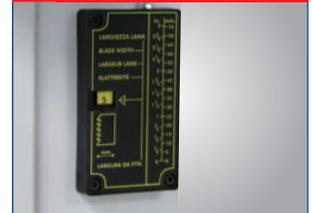
· Am Maschinenrahmen integrierte Anzeige der Sägebandspannung für verschiedene Bandbreiten
