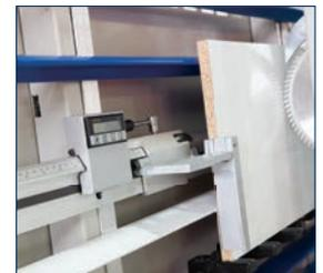
• Digitale Maßanzeige zur Längeneinstellung beim Vertikalschnitt
