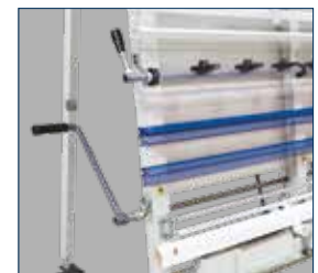
• Um zu verhindern, dass das Sägeblatt in eine Rückwandlatte hinein-sägt, Lattenrost manuell verschiebbar
