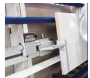
• Digitale Maßanzeige zur Längeneinstellung beim Vertikalschnitt
