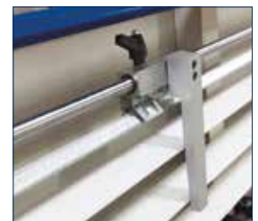
• Lineal zur Längeneinstellung beim Vertikalschnitt
