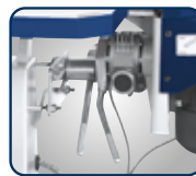
Schleifaggregat über Hebel bis 45° schwenkbar
