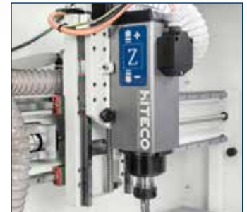
• Hochwertige Elektro-Frässpindel vom erfahrenen Hersteller Hiteco
