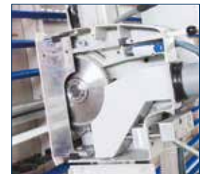
• Große Öffnung für Sägeblattwechsel
