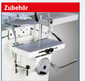
Langlochbohrereinrichtung in Guss-Ausführung Art.-Nr.: 5514330
