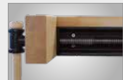
Massive Linearführung an der Hinterzange
