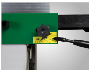
Verstellung der Spanabnahme über Bedienhebel
