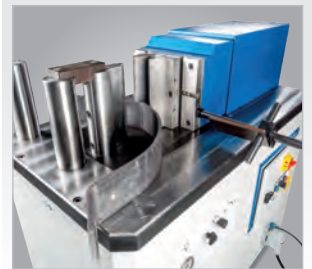
▶ Mit Schnellwechselaufnahme und Seitenanschlag mit Skala
