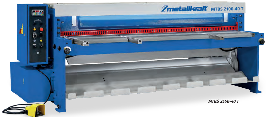
▶ Rückraumsicherung nach CE mit Seitenblechen und Lichtschanke
