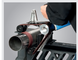
▶ Nur zwei Arbeitsschritte notwendig für 360° Umfangschleifen
