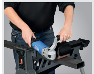
▶ Satinieren von flachem Material
