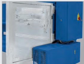
▶ Rückraumsicherung nach CE mit Seitenblechen und Lichtschanke
