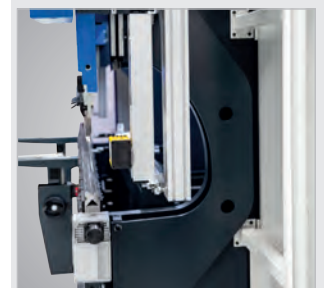
▶ CNC-gesteuerte, motorische Bombierung
