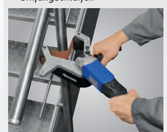
▶ Besonders geeignet für den Einsatz im Geländerbau
