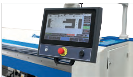
Bedienerfreundliche 15,6“ Touchscreen NC-Steuerung an ergonomischen Schwenkarm
