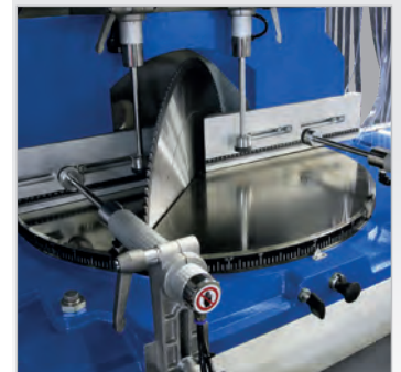
▶ Stufenlose Verstellung des Gehrungswinkels
