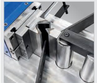
▶ Mit Schnellwechselaufnahme und Seitenanschlag mit Skala
