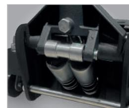
Quick-Lift Funktion durch Doppelkolben
